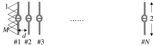
Fig. 1 Analysis model: A linear dipole array antenna.
