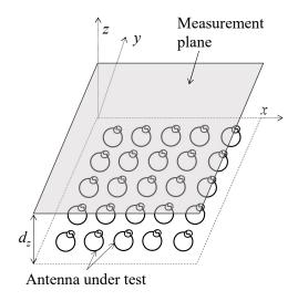
Fig. 1. Loop array antenna.
