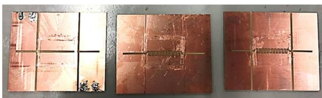
(a)スロット線路 (b)メアンダ線路1 (付加スロット幅0.1mm) (c)メアンダ線路2 (付加スロット幅1mm)
