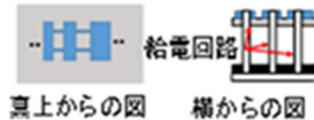
(b) トリプレート構造 地板面に給電回路がある場合
