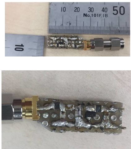
図9 制作した 6.78MHz 帯整合回路付き整流回路
